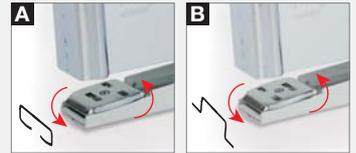
Nella posizione punto aperto **B** permette, nel caso necessari, la rimozione del punto manualmente, evitando così la cucitura permanente dei fogli (max 3).
