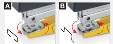
Nella posizione punto aperto **B** permette, nel caso necessari, la rimozione del punto manualmente, evitando così la cucitura permanente dei fogli (max 3).
