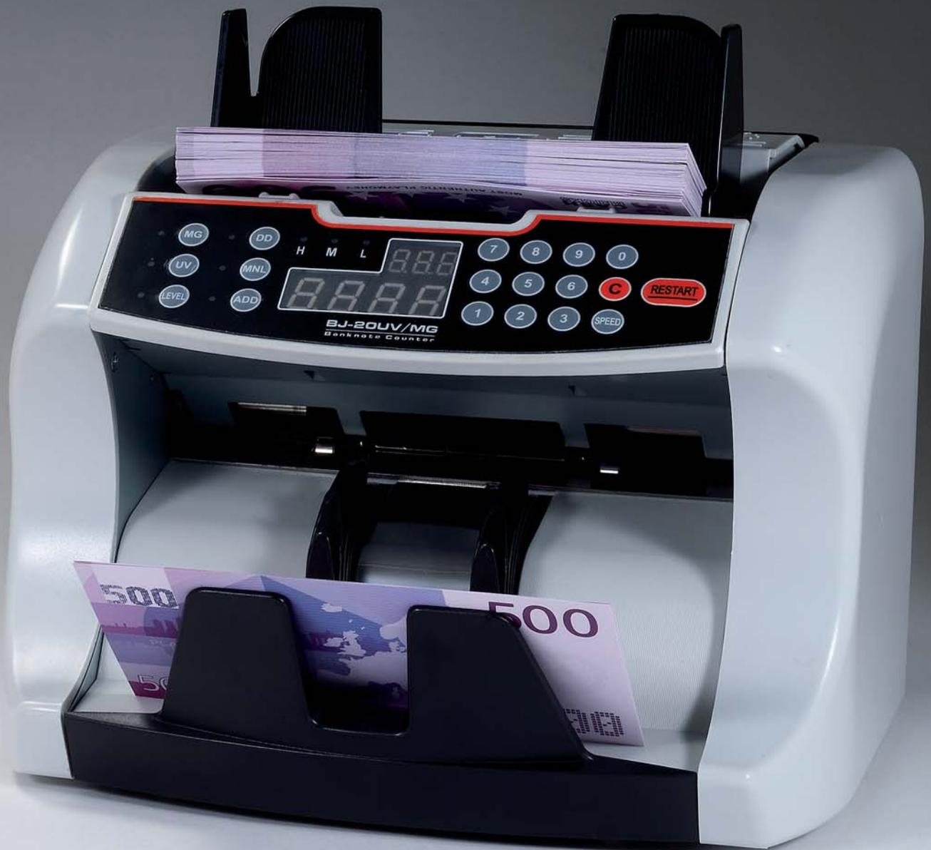
Verificatore di banconote dotato di lampada di Wood ad elevata luminosità, doppio sensore magnetico per la verifica della presenza del filo magnetico, doppio led bianco per la verifica della presenza della filigrana e della microscrittura. Dimensioni compatte.
